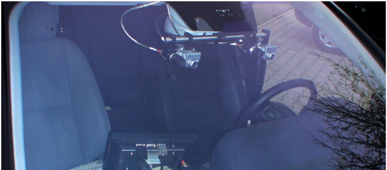
**Abbildung 4.2.11.:** Befestigung des Stereokamerapaars im Versuchsfahrzeug
