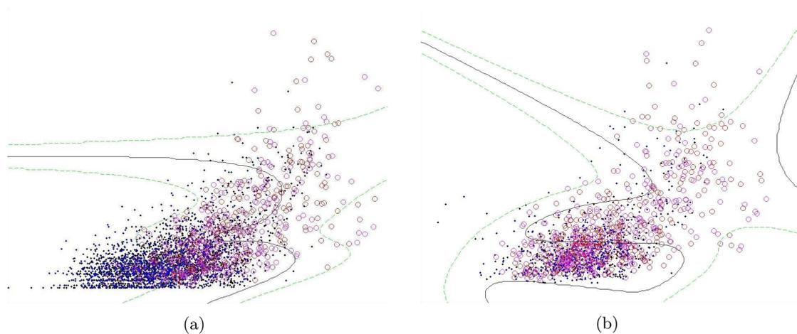
Abbildung 4.7: Bayes-Klassifikation für die Merkmale Flächeninhalt (x-Achse) und Formfaktor (y-Achse) in den Skalen  $\sigma = 1$  (a) und  $\sigma = 4$  (b). Dargestellt sind die Merkmalsausprägungen von stabilen Regionen in Gebäuden als blaue Punkte und Merkmalsausprägungen von stabilen Regionen im Hintergrund als rote Kreise. Die durchgezogene Linie kennzeichnet die Grenze zwischen den Klassen. Die gestrichelte Linie stellt den Fehlersaum dar.
