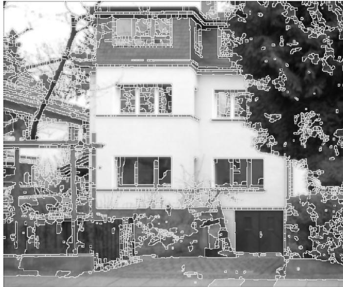
Abbildung 3.4: Darstellung eines Grauwertbildes  $b_{gr}(x_1, x_2)$  mit Wasserscheidenregionen. Regionen im Bereich der hellen Fassade weisen eine größere Homogenität auf als Regionen im Bereich von Vegetation.
