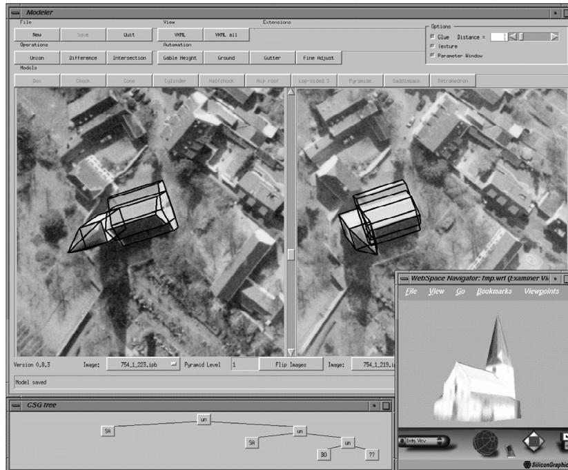
Abbildung 1: Graphische Benutzeroberfläche (GUI) des Semiautomatischen Systems zur Erfassung von 3D-Stadtmodellen. In den zwei Bildausschnitten sind die angepassten Primitive als Drahtgittermodelle dargestellt. Links unten ist die CSG-Baumstruktur visualisiert und rechts unten die texturierte 3D-Darstellung des gesamten Gebäudekomplexes.
