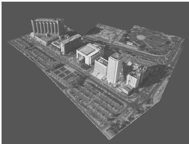
Abbildung 8: Oben: Luftbildausschnitt (Copyright Luftbild: Aufnahme Hansa Luftbild GmbH). Mitte: Extrahierte Gebäude- und Objektmodelle (bei bekannter Bodenhöhe aus nur einem Bild. Unten: 3D-Gesamtansicht der extrahierten Gebäude (0.2 m Texturelementgröße) mit Teilen der Straßenfläche und Vegetation (1.5 m Texturelementgröße)
