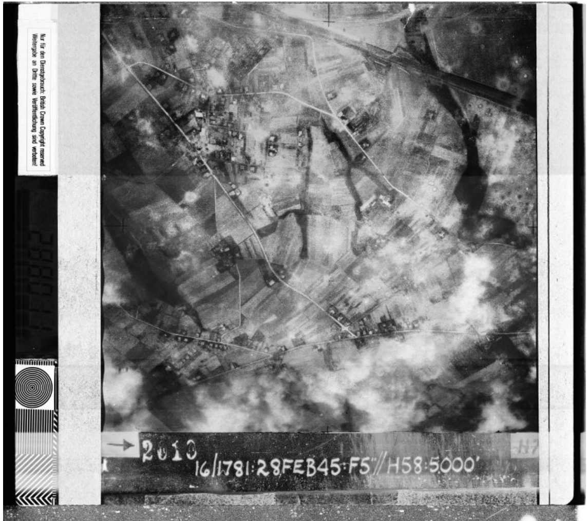
Figure 15: Bildverbesserung mit zeilenweisem Dodging ohne Interpolation
