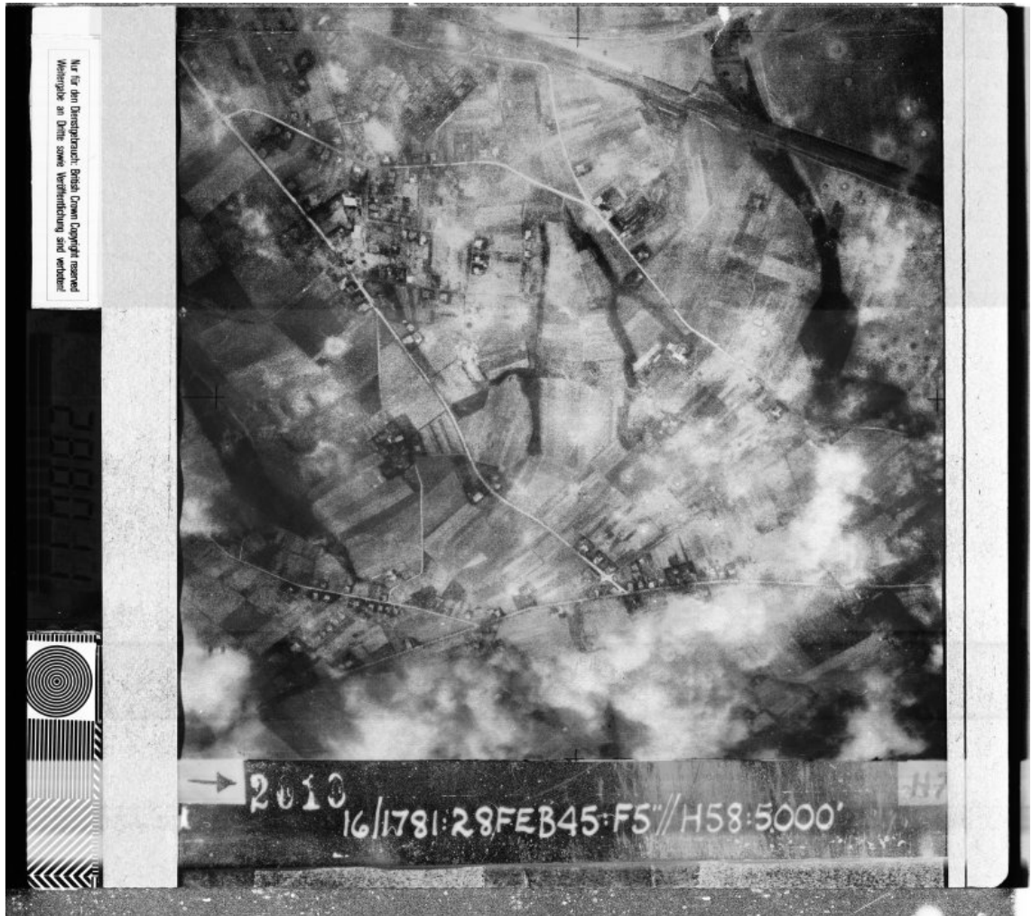
Figure 16: Bildverbesserung mit zeilenweisem Dodging mit Interpolation
