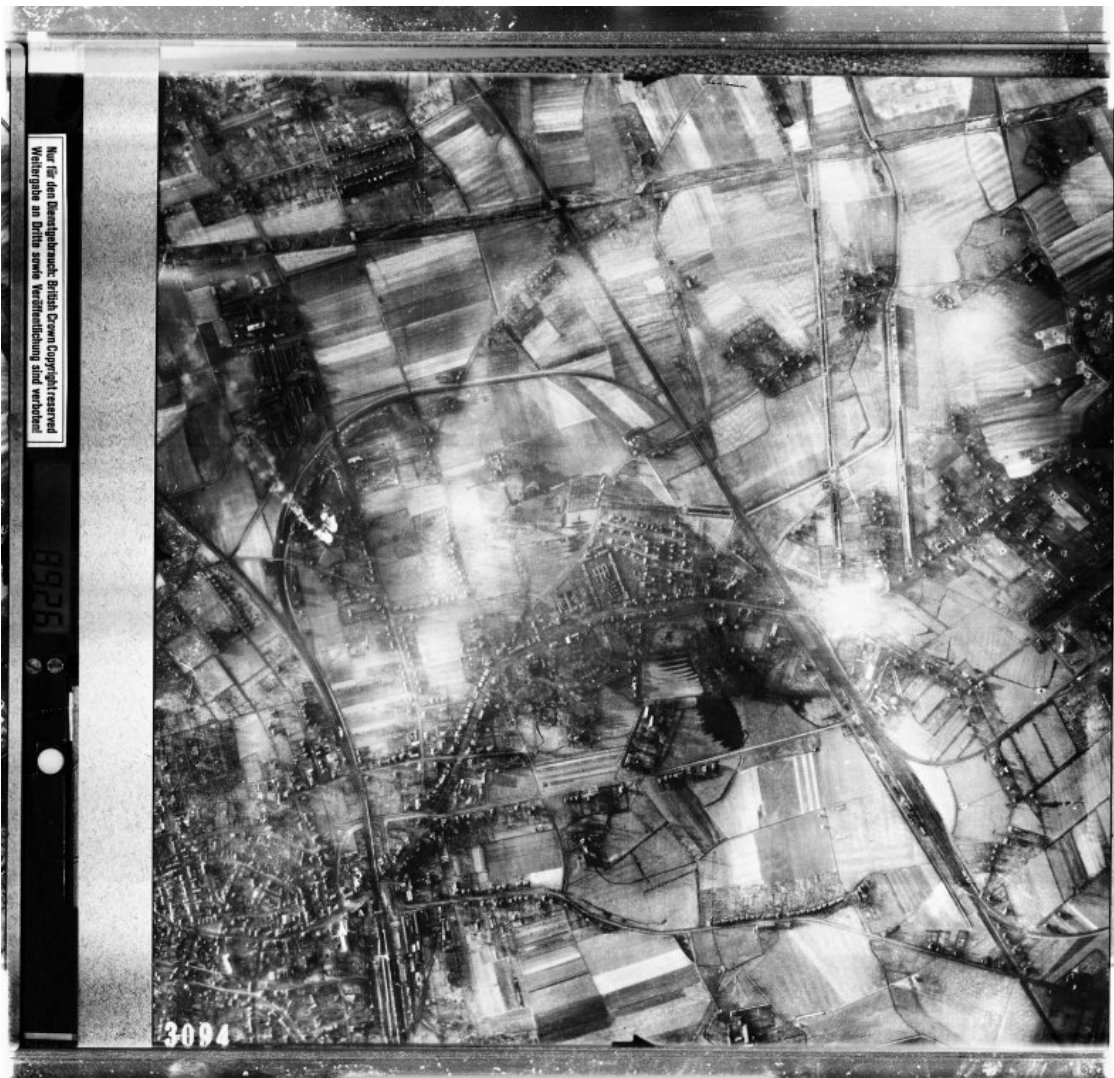
Figure 5: Bildverbesserung mit zeilenweisem Dodging ohne Interpolation
