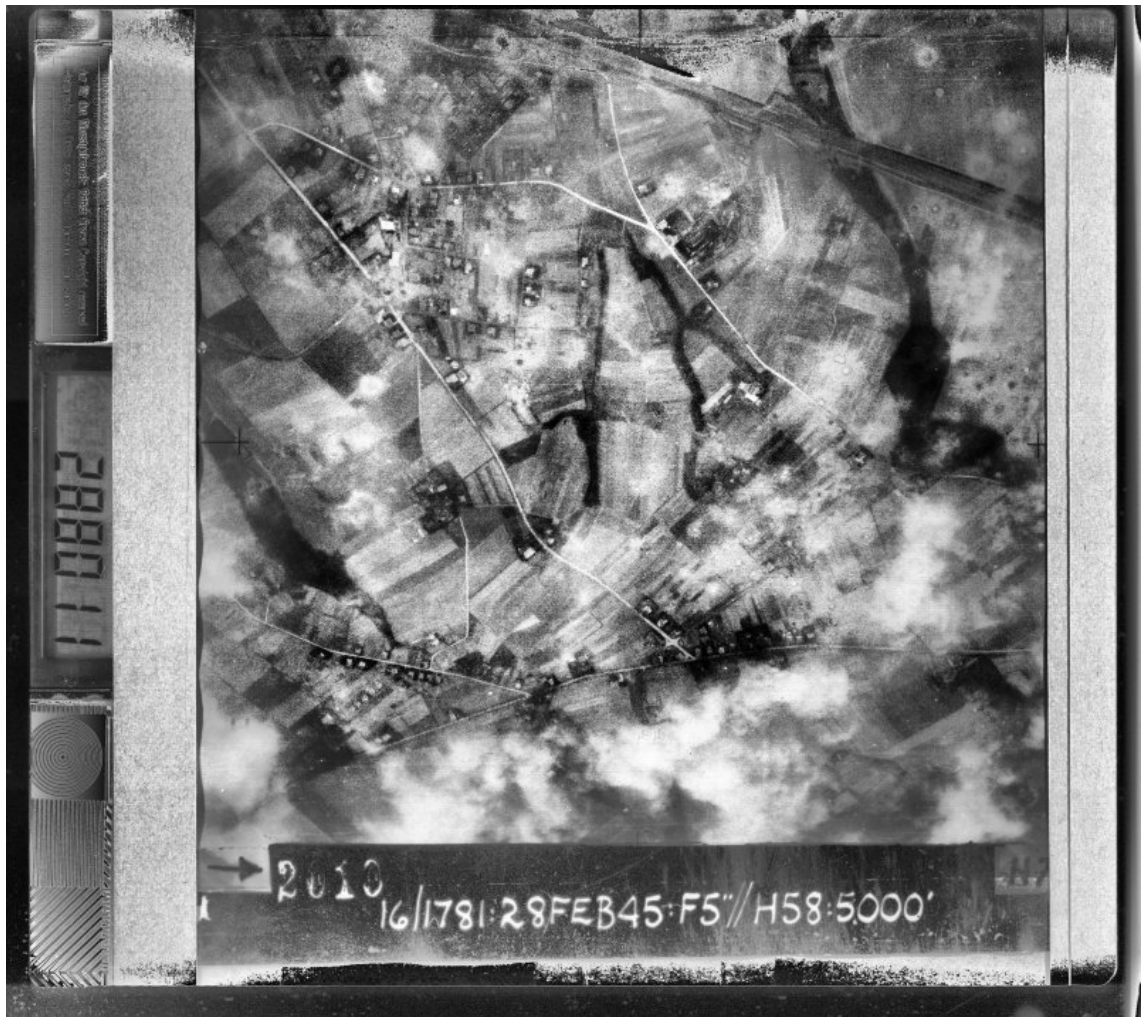
Figure 18: Bildverbesserung mit patchweisem Dodging mit Interpolation
