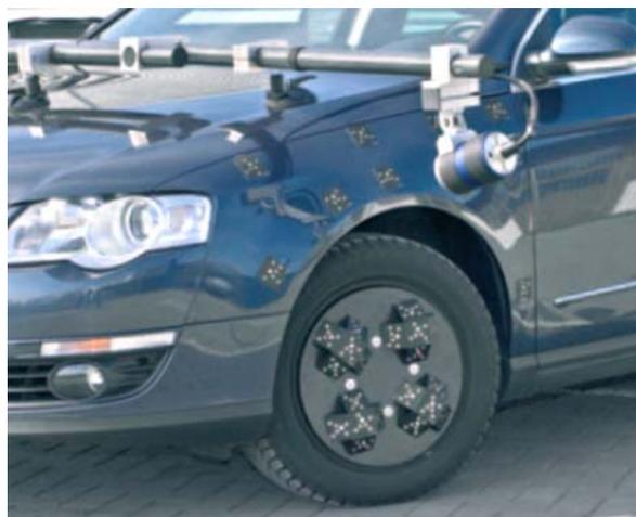
Abbildung 3.1: WHEELWATCH der Firma AICON 3D Systems GmbH mit Messmarken am Kotflügel des Fahrzeugs und einem Radadapter (Aicon, 2008)
