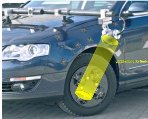
Abbildung 10.4: Problematik des gefährlichen Zylinders mit dem Radadapter der Firma AICON 3D Systems GmbH
