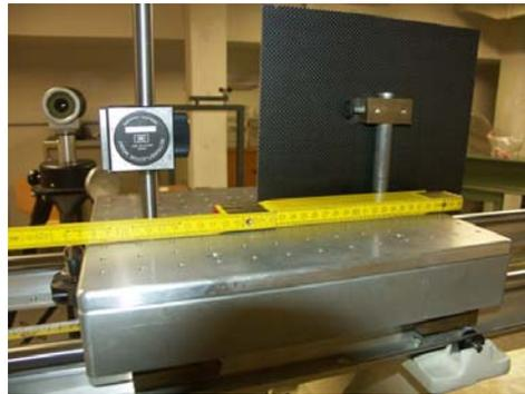
Abbildung 5.16: Aufbau und Montage des Schlittens an der Geradheitsbahn der Universität Bonn mit Prisma für das Interferometer und Adapter für die Onlinemesssysteme
