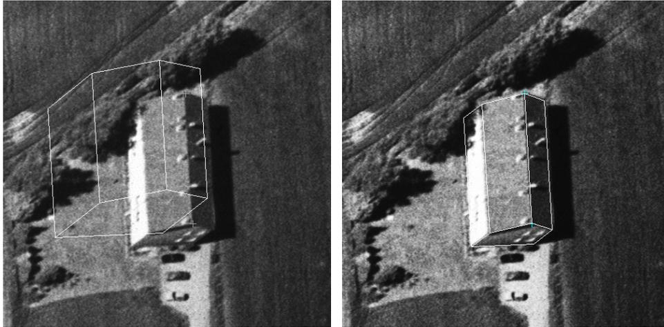
Abbildung 3: Mit Hilfe einer robusten Ballungsanalyse wird mit den in allen Bildern extrahierten Bildkanten die tatsächliche Höhe des Gebäudeteils und damit die absolute Größe automatisch bestimmt. Das Histogramm zeigt die Wahrscheinlichkeit an, daß das Gebäude in einer bestimmten Höhe liegt.
